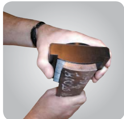
▲ Okładziny szczęk o zakrzywionej powierzchni są dostosowane do średnic wewnętrznych i zewnętrznych próbek przewodów rurowych, aby zapewnić pewne uchwycenie zaokrąglonych próbek podczas wykonywania prób.
