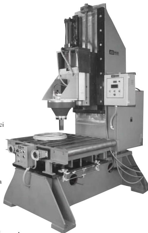
▲ Twardościomierz Brinella produkcji Wilson Instruments z bezpośrednim odczytem.
