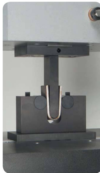
▲ Próba zginania z prowadzeniem próbki spoiny według normy ASTM E 190.
