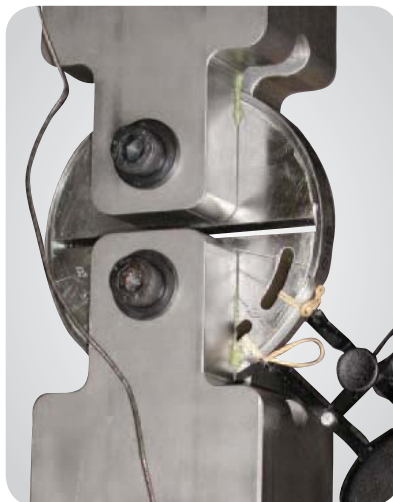
▲ Próba wzdłużna przekroju poprzecznego przewodu rurowego.
