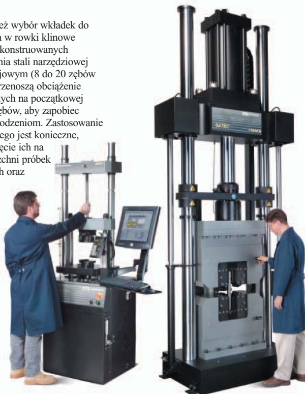
▲ Maszyna 3000X serii SATEC™ z uchwytami klinowymi wbudowanymi w głowicę (z lewej strony), maszyna serii SATEC o zdolności obciążeniowej 1500 kN z siłownikiem zamontowanym w górnej części dla ułatwienia załadunku dużych, ciężkich próbek prętów zbrojeniowych (z prawej strony).
