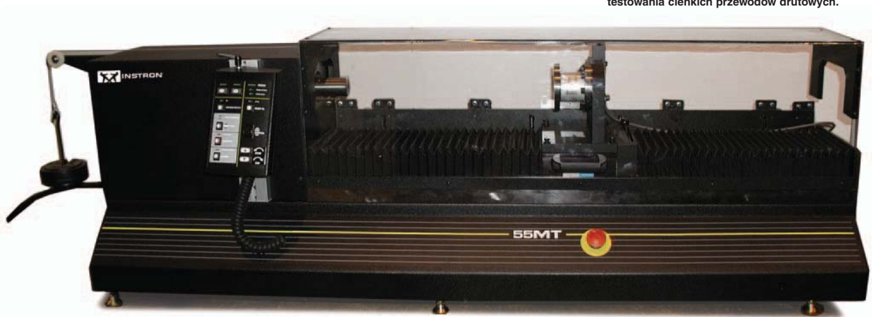
▲ Maszyna 58MT z układem ciężarka i krążka linowego (z lewej strony) do przykładania wstępnego obciążenia wzdłużnego.
