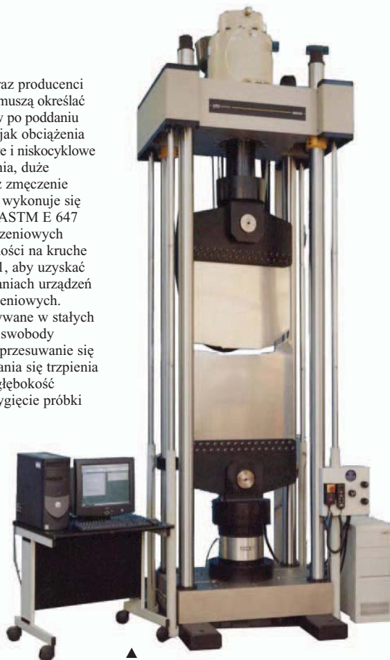
▲ System do prób zmęczeniowych płaskich płyt o zdolności obciążeniowej 1MN (22500 kip).
