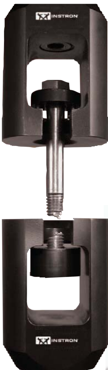
▲ Obsady elementów złącznych firmy Instron serii B (W-5117B) z podkładkami płaskimi podczas wykonywania standardowej próby rozciągania.
