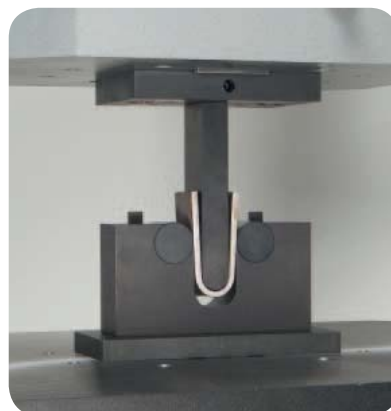
▲ Próba zginania próbki blachy grubej z prowadzeniem.
