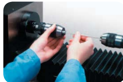
▲ Model 55MT1 systemu do prób skrećania wyposażony w uchwyty tokarskie do testowania przewodów drutowych.
