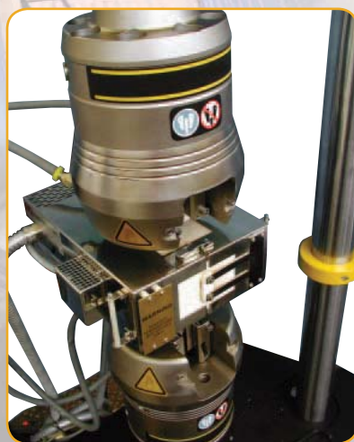
▲ Krótki piec o temperaturze +1400 °C (+2552 °F) oraz uchwyty hydrauliczne z chłodzeniem wodnym.
