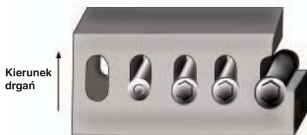
▲ Typowa przystawka do badania odporności na drgania według NASM 1312-7.
