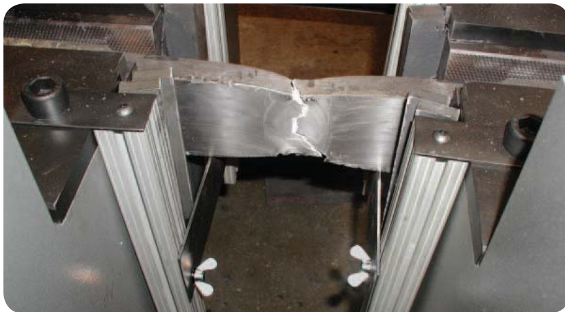
▲ Klinowe chwyt hydrauliczne o wysokiej zdolności obciążeniowej z przegubowymi szczękami. Uchwyt otwiera się automatycznie, aby ułatwić zakładanie i zdejmowanie próbek o rozmiarach do 127 mm x 127 mm x 1016 mm (5 in x 5 in x 40 in).
