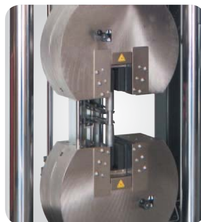
▲ Pneumatyczne uchwyty o działaniu klinowym o zdolności obciążeniowej 300 kN (67500 lbf) oraz automatyczny ekstensometr M300 o długości pomiarowej 200 mm (7,87 in.).
