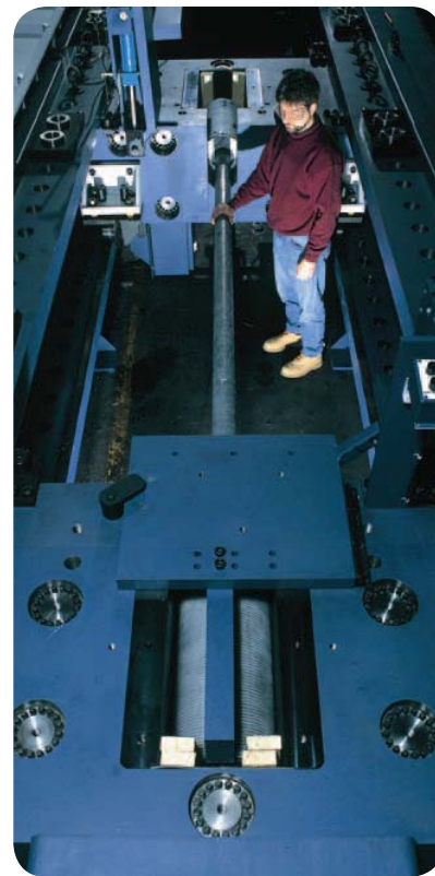
▲ Poziomy system do prób serii SATEC™ o zdolności obciążeniowej 10 MN (2250000 lbf) do testowania lin stalowych.
