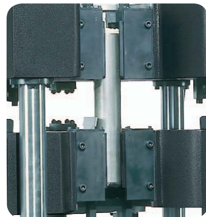
▲ Uniwersalna maszyna do badań wytrzymałościowych serii SATEC™ o zdolności obciążeniowej 600 kN (135000 lbf), z otwartą konstrukcją przedniej części belki pomiarowej i wbudowanymi w belkę uchwytami do badań próbek przewodów rurowych o pełnym przekroju.
