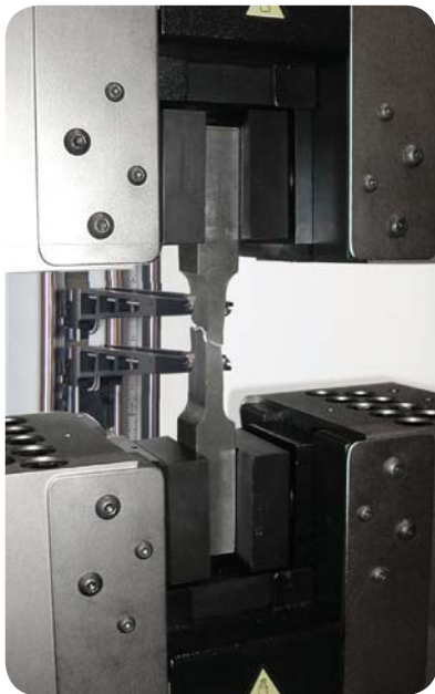
▲ Ekstensometr M300 wykonuje pomiar odkształcenia próbki oraz automatycznie zamocowuje się i zwalnia.
