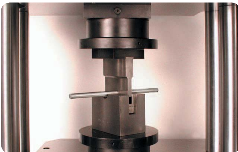
▲ Wykonywanie próby podwójnego ścinania próbki pręta.
