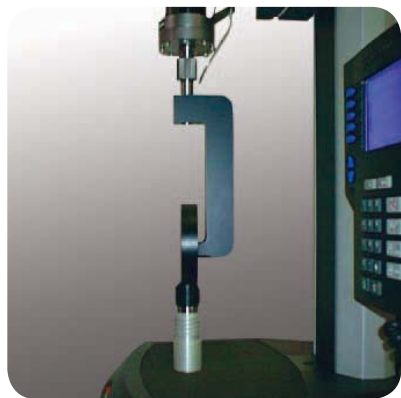
▲ Przedłużacz Gooseneck ułatwiający wykonywanie prób wewnętrznych.
