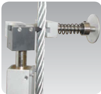
▲ Ekstensometr firmy Instron do kabli model CE posiada ruchomą głowicę, która obraca się w miarę rozwijania kabla wskutek rozciągania.
