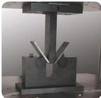
▲ Próbkę ze spoiną podczas próby zginania z prowadzeniem.
