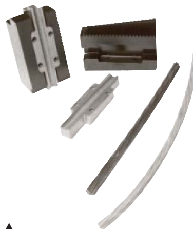
▲ Uchwyty wbudowane w głowicę posiadają wymienne wkładki do przeprowadzania prób kabli o różnych średnicach.
