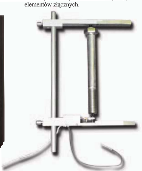
▲ Ekstensometr SEB z czujnikiem tensometrycznym do pomiaru wydłużeń śrub.
