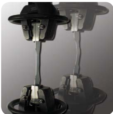
▲ W celu wyeliminowania możliwości wystąpienia nadmiernych sił rozciągających lub ściskających podczas wstępnego zaciskania uchwytu można uaktywnić funkcję Specimen Protect, aby uniknąć uszkodzenia cienkiej lub delikatnej próbki.
