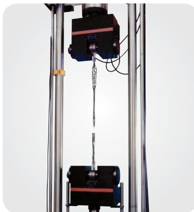
▲ System do prób zmęczeniowych podczas wykonywania próby liny drucianej.
