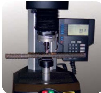
▲ Maszyna Wilson® Instruments Rockwell 2000 wykonująca próbę twardości próbki pręta zbrojeniowego z zastosowaniem stołka waleczkowego (Cylindron).
