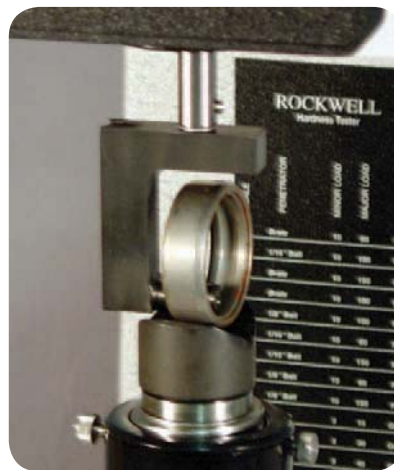
▲ Standardowa przystawka Gooseneck do prób twardości na powierzchni wewnętrznej materiału.
