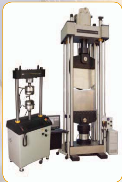
▲ System do prób zmęczeniowych 8801 (z lewej strony) oraz 8805 (z prawej strony).
