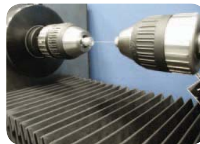
▲ Maszyna 55MT1 z uchwytami z tuleją zaciskową do testowania cienkich przewodów drutowych.
