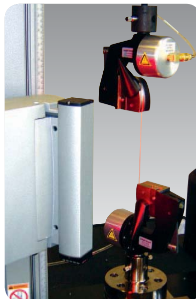
▲ Uchwyty dla sznurka i przędzy oraz zaawansowany, bezdotkowy ekstensometr wideo.
