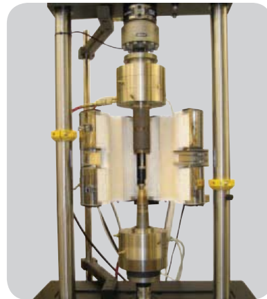
▲ Piec o temperaturze +1000 °C (+1832 °F) z ciągłymi o wstępnym obciążeniu hydraulicznym dla prób niskocyklowego zmęczenia (LCF) materiałów przeznaczonych dla przemysłu lotniczego i kosmicznego.
