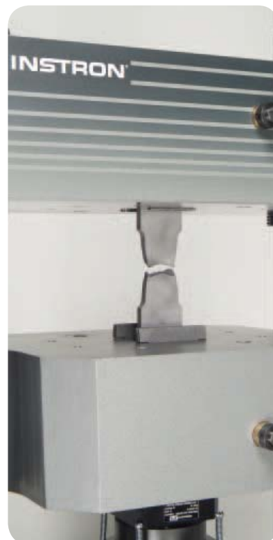
▲ Model 600DX serii SATEC™ z wbudowanym w poprzeczną belkę pomiarową uchwytem klinowym do wykonywania badań próbek blach grubych przy obciążeniach do 600 kN (135000 lbf).
