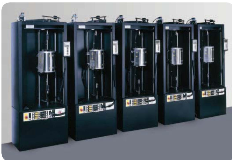
▲ Model M3 maszyny do prób pełzania i destrukcji materiałów pod wpływem naprężenia.
