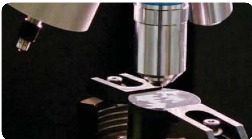
Maszyna Tukon 2100 firmy Wilson Instruments podczas próby mikrotwardości przeprowadzanej na powierzchni przekroju poprzecznego zamocowanej próbki.
