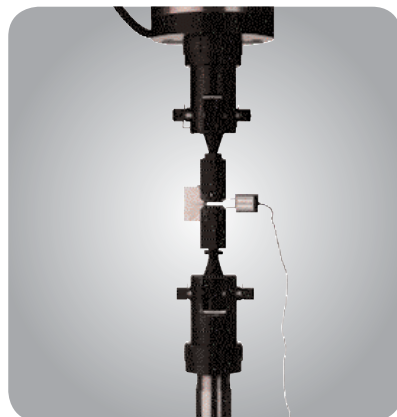
▲ Badanie mechaniki pęknięć przy użyciu uchwytów CT oraz przyrządu pomiarowego COD.
