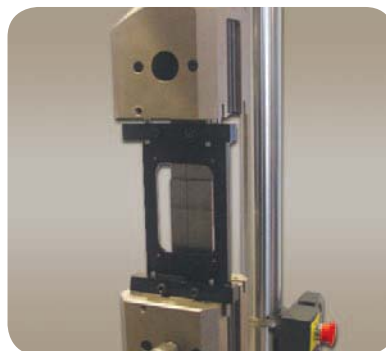
▲ Pozycjonowanie spoiny punktowej w osi obciążenia.
