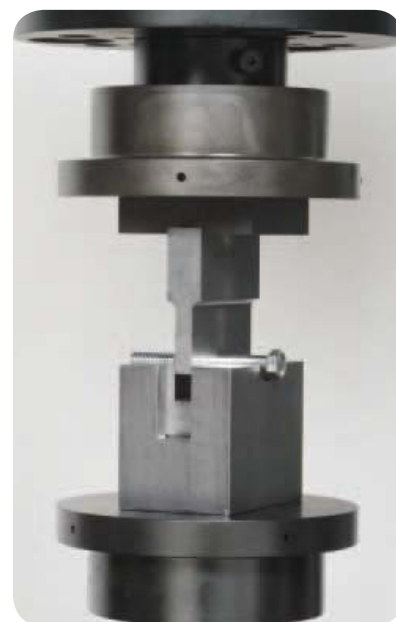
▲ Przystawka do prób ścinania podwójnego (W-5135).
