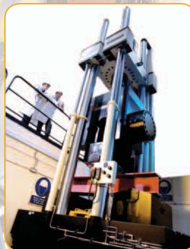
▲ System do prób zmęczeniowych o zdolności obciążeniowej 5 MN (112500 kip), wyposażony w uchwyty o działaniu bocznym.
