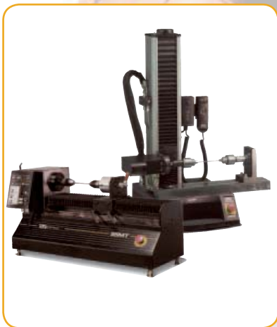
▲ Maszyna do prób skręcania Dynamight™ oraz 55MT1.
