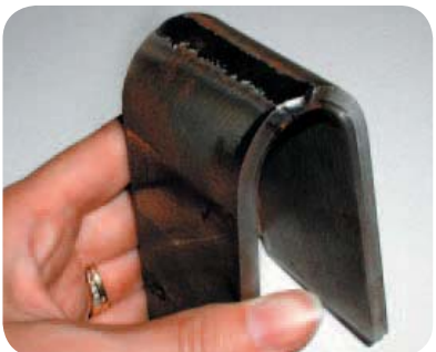
▲ Spoinę sprawdza się wizualnie po wykonaniu próby pod względem występowania pęknięć i defektów.
