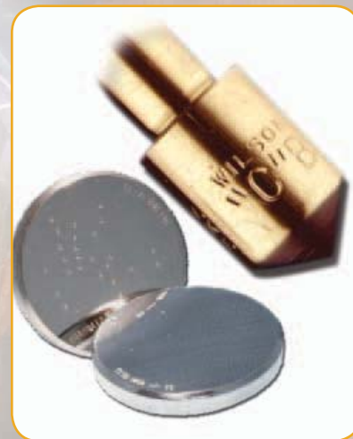
▲ Bloki wzorcowe do prób twardości oraz wgłębnik twardościomierza.
