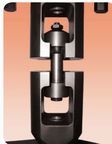
▲ Trzpień do obciążania nakrętek obciążeniami sprawdzającymi jest wykorzystywany do testowania jakości gwintu nakrętek.
