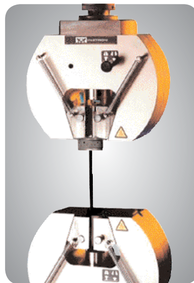
▲ Pneumatyczne uchwyty o działaniu klinowym firmy Instron, o zdolności obciążeniowej 100 kN (22480 lbf), wykorzystywane do oceny wytrzymałości na rozciąganie zgrzewanych lub spawanych elementów.
