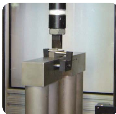
▲ Maszyna Dynatup® model 9250 podczas wykonywania testu udarowościowego Charpy'ego spawanej próbki.
