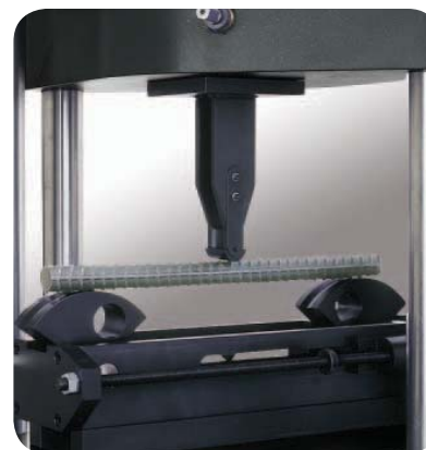
▲ Przystawka do prób zginania na zimno (numer katalogowy W-1231), przeznaczona do prób zginania prętów zbrojeniowych.
