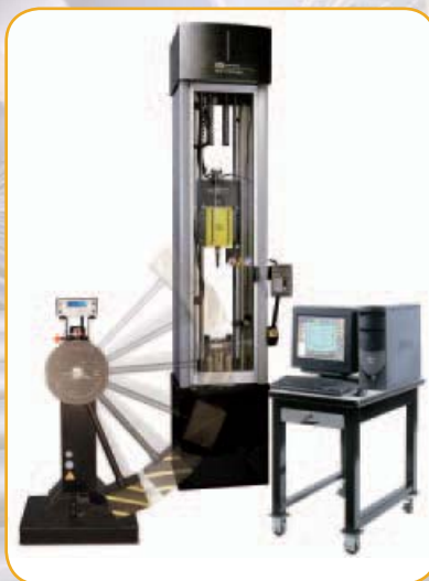
▲ Maszyna udarowościowa Dynatup wahadłowa (z lewej strony) i opadowa (z prawej strony).
