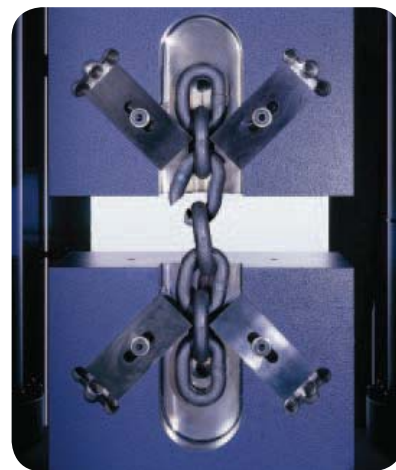
▲ Urządzenie VTL serii SATEC z uchwytami do łańcuchów.
